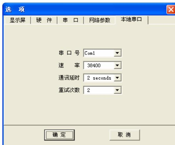
步骤四：最后选择[串口]，并重新给控制卡上电，则软件界面出现控制卡的串口配置界面，按照提示操作即可。（串口设置只涉及选项1-6，'N'和'G'用于在网络通讯完全失败时进行修复）
