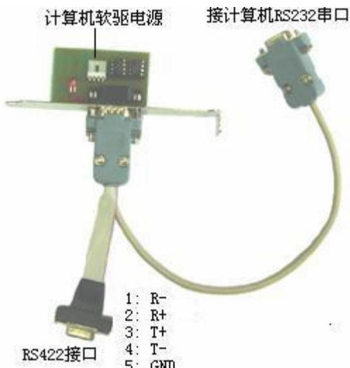
转换器 RS422 接口 PIN1  $\longleftrightarrow$  Supercomm 控制卡 COM3 PIN6
