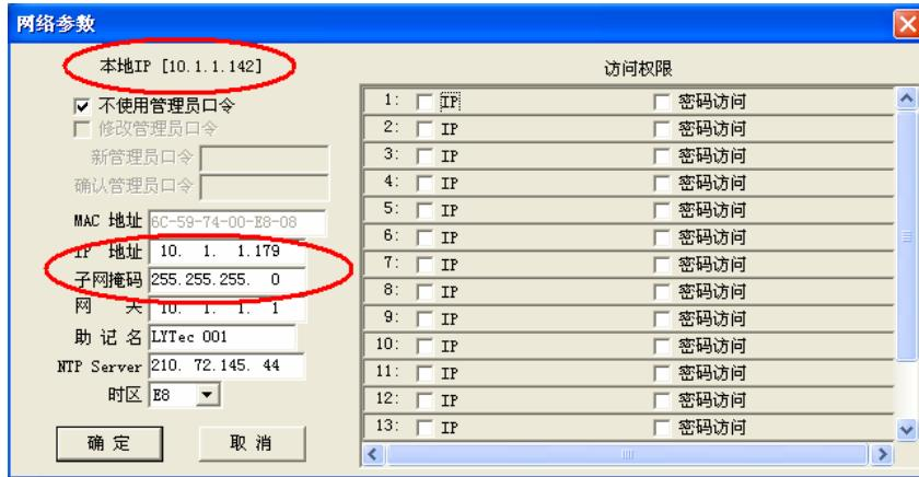
先在子网掩码一栏输入刚才在计算机的本地连接中获取的子网掩码。然后根据网络参数设置见面上方提供的本地 IP(计算机的 IP)和子网掩码设置显示屏的 IP 地址。
